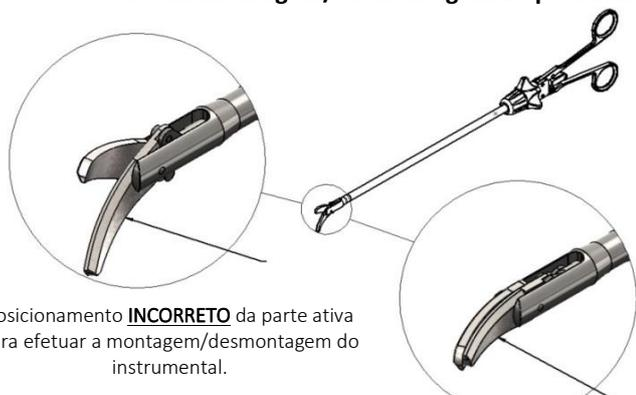
Posicionamento **INCORRETO** da parte ativa para efetuar a montagem/desmontagem do instrumental.
